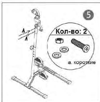
5. Прикрепите ручки к стойке велотренажёра с помощью двух комплектов крепёжных деталей – по два коротких винта 5 x 58мм и две шайбы. Крепёжные детали следует устанавливать в направлении А, указанном на рисунке 5. Затягивайте винты до тех пор, пока ручки не примут стабильное положение.
