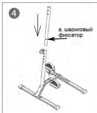
4. Нажмите на шариковый фиксатор, затем установите верхнюю часть стойки в нижнюю таким образом, чтобы фиксатор попал в одно из отверстий на нижней части стойки.
