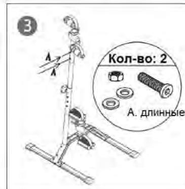
3. Вставьте стойку в опорную конструкцию, закрепите её с помощью двух длинных винтов 8 x 50мм и двух шайб – для крепления одной стороны понадобится изогнутая шайба, для другой – плоская шайба. Затягивайте винты до тех пор, пока стойка не примет стабильное положение.
